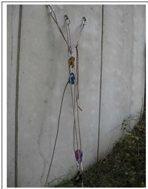
Polipasto confeccionado con una Protraxion, un bloqueador y una polea P50, véase en la imagen la colocación de un mosquetón adicional en el orificio de la protraxion, para evitar que las placas oscilantes se abran.
